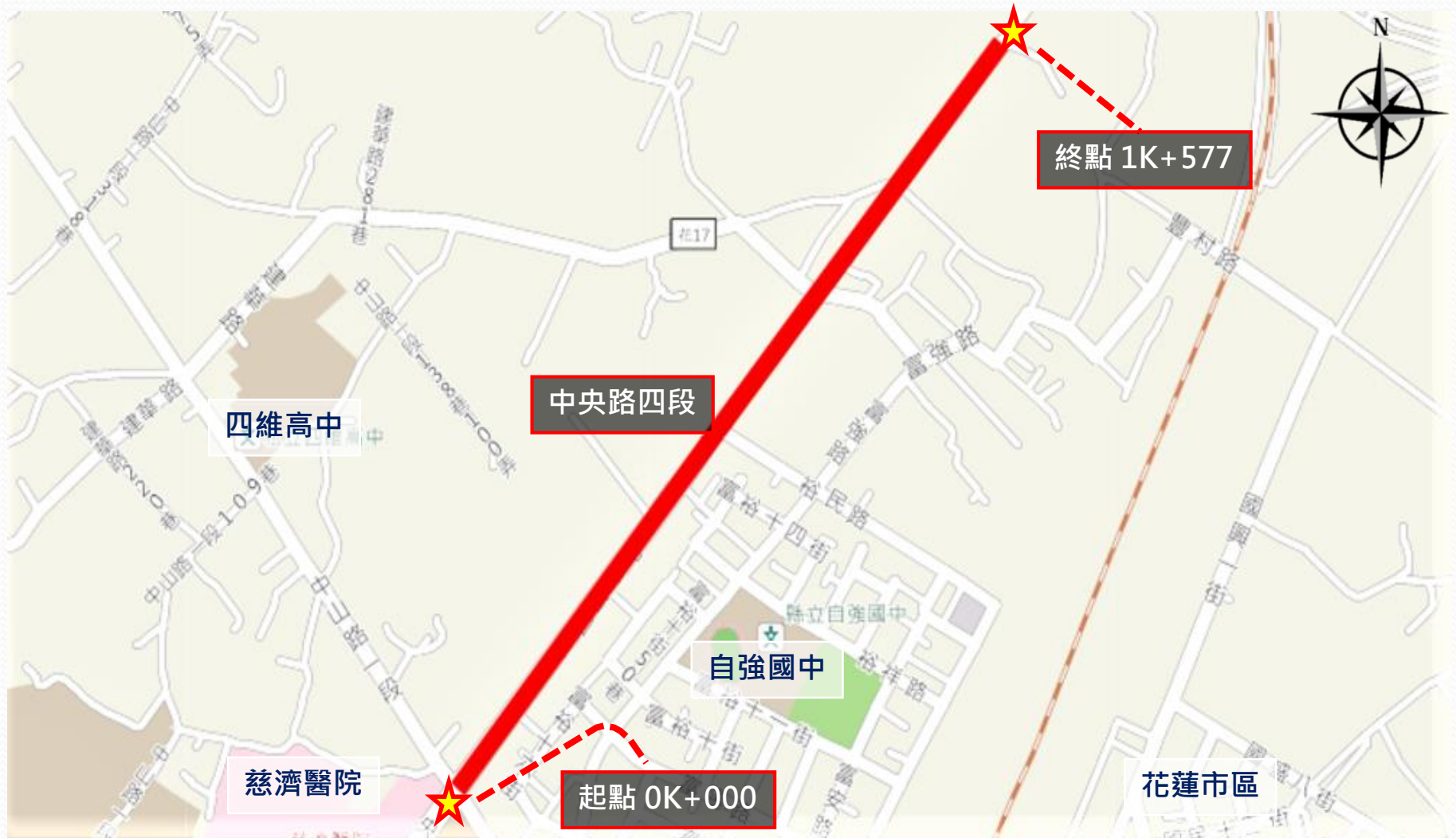
工程地點位於花蓮市中央路四段0K+000為起點至1K+577終點， 路面寬30米，雙線雙車道。
